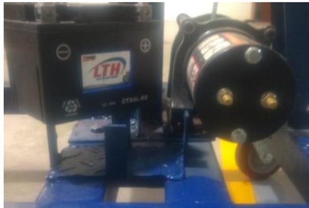
**Figura 70.** Base de seguridad para batería.
