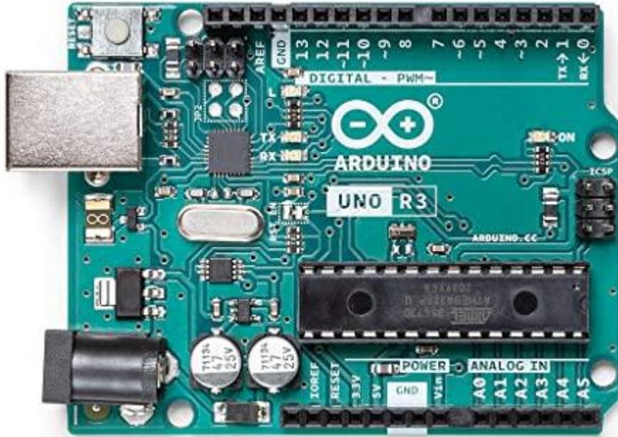
**Figura 5.** Placa Arduino Uno [2].
