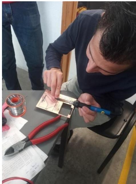
**Figura 49.** Soldando los componentes eléctricos.
