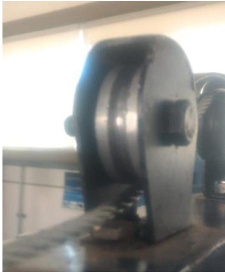
**Figura 69.** Polea con recubrimiento de seguridad.
