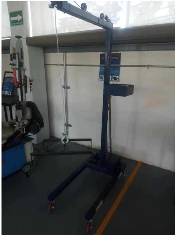
**Figura 74.** Estructura final del vehículo-grúa semi automatizado.
