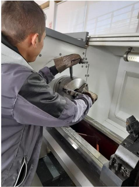
**Figura 36.** Fabricación de las poleas en las maquinas CNC.
